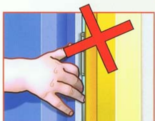
Der gefährliche Spalt an der Scharnierseite der Tür...
